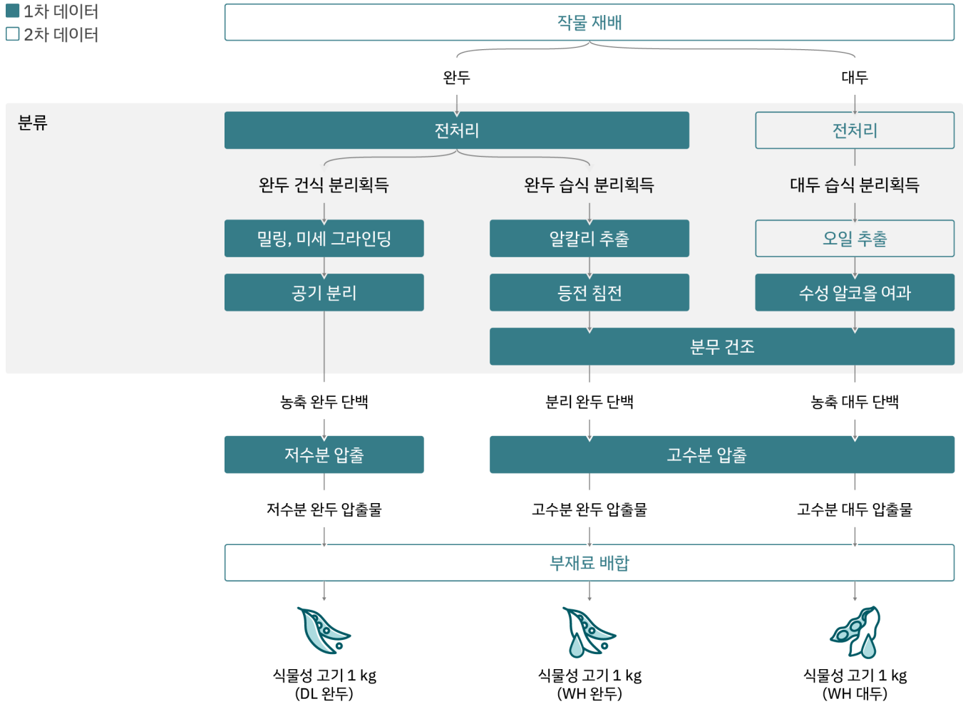
그림 1. 식물성 고기 생산의 LCA 진행 과정(작물 재배부터 분리획득, 압출, 배합까지의 전 과정 포함)
